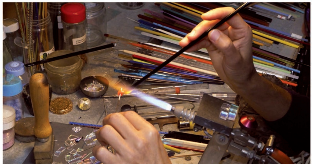
Técnica de fusión en vidriería artesanal
